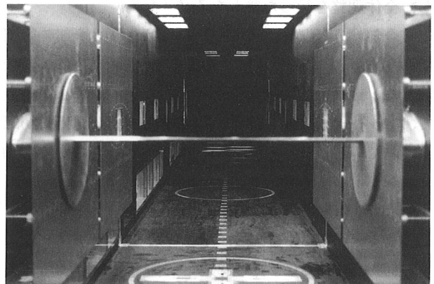
写真-1 3分力天秤に設置した模型
