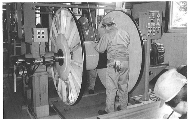
写真-4 パイロットロープの巻き付け
