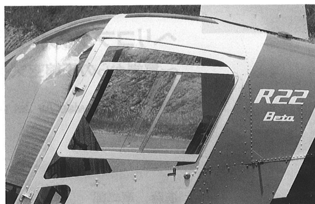
写真3 ロビンソンR22の前後開閉式斜め写真窓
