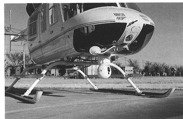
写真5 ツインライナーの胴体下に設置された CCDカメラ付き赤外線カメラ
