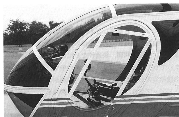
写真4 シュワイザー330の上下開閉式斜め写真窓
