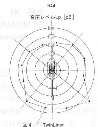
図5 機体周囲の騒音レベル分布 (マスト中心より9 mの同心円上で測定)
