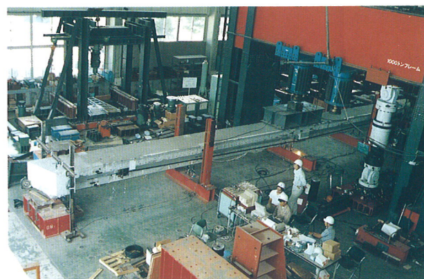
写真3 静的載荷試験状況
