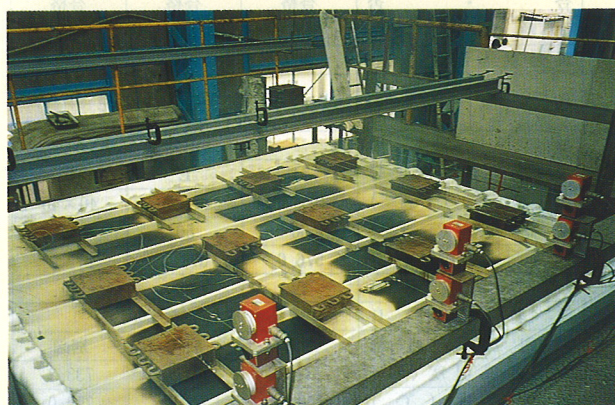
写真6 屋根耐火30分加熱載荷試験体状況（外部）
