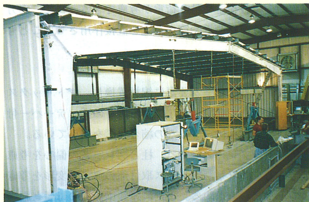
写真3 鉛直載荷実物大試験中
