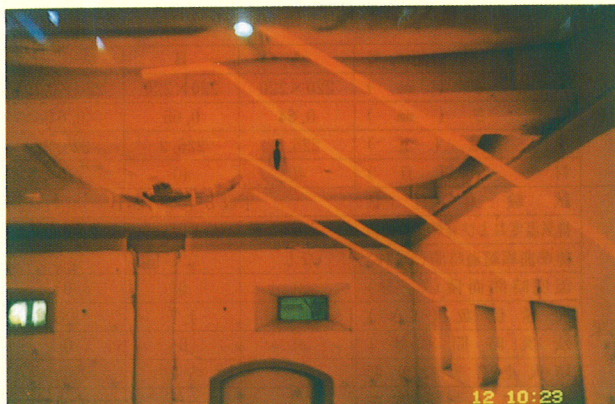
写真5 屋根耐火30分加熱載荷試験体状況（内部）
