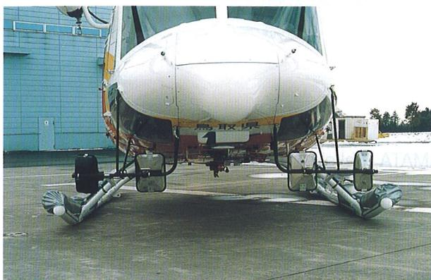
前述のベル412固定式ミラーの改良型とも言うべきもので、操縦士用の外側ミラー（写真左側）を電動による位置調整式としました。操縦士はコック・ピット内のコントローラを操作することにより、上下各30度、左右各15度のミラーの位置調整ができるため、胴体右側面のレスキュー・ホイストからカーゴ・スリング下の吊り下げ荷物まで広範囲の監視が可能となっています。また、副操縦士用のミラーも2枚としました。本カーゴ・ミラーは平成10年1月に完成しました。
