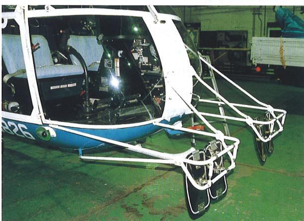
アエロスパシアル式SA315型は、物資輸送に使用されることが多く、胴体下のカーゴ・スリングおよびその下の吊り下げ荷物を監視することが、カーゴ・ミラーの目的となっています。したがって曲面ミラー2枚を使用し、1枚は胴体下面を、もう1枚は吊り下げ荷物を監視するための固定式となっています。また、操縦練習時に副操縦士席からも監視可能なように、左右に独立したカーゴ・ミラーを装備していますが、通常はパイロット側のみの装備で運航しています。このカーゴ・ミラーは、平成9年12月に完成し、東邦航空(株)の運航する3機のヘリコプターに装備しました。
