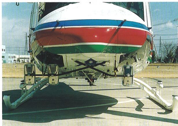
ベル式412EP型は、消防防災ヘリコプタとして、各都道府県に数多く配備されています。消防防災ヘリコプタのカーゴ・ミラーの用途は非常に多く、胴体下面のカーゴ・スリングや消火タンク、およびその下方の消火バケットや吊り下げ荷物、さらには胴体右側面のレスキュー・ホイストやラペリングなど、すべての用途に応じて操縦士が監視できなければなりません。したがって、本カーゴ・ミラーは以下のようないくつかの特長となっています。
