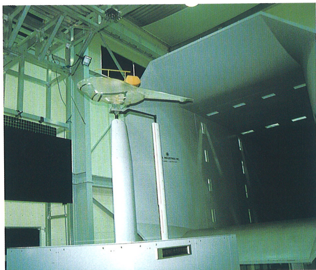
模型が風洞に設置された様子
