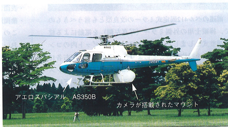
航空測量用カメラを装着したヘリコプタのテスト飛行
