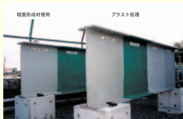
写真4 亜鉛・アルミ擬合金溶射試験体
