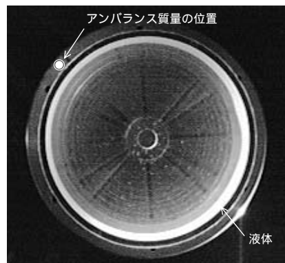
ベッセル：フェンスなし サスペンション：ワイヤロープ 液体：グリセリン+水 ( \rho = 1.13 ), 50ml 回転数：800rpm
