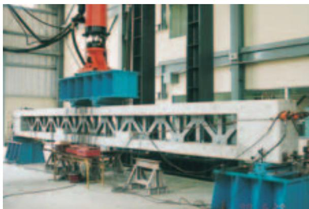
写真3.3 鋼トラスウェブPC梁（荷重試験状況）
