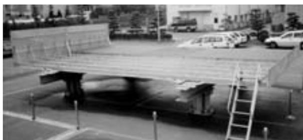
写真1 SCデッキの実物大模型
