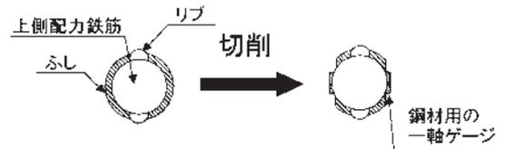
図6 上側配力鉄筋 鋼材用の一軸ゲージ取付け位置
