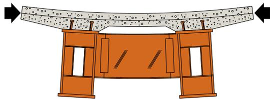
従来の構造は鋼桁にもプレストレスが伝わる
