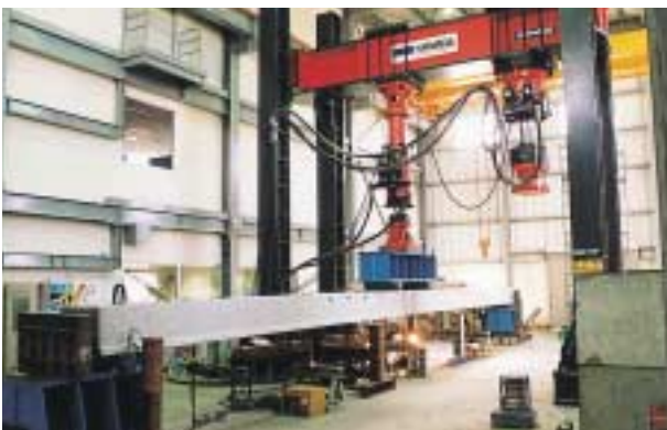
実物大プレテン桁の載荷試験状況
