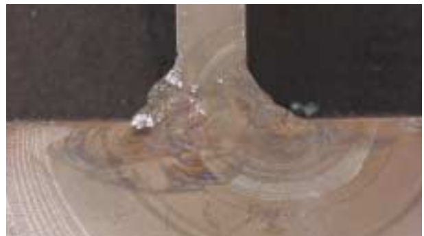
ノンスカラップ構造部の疲労破面
