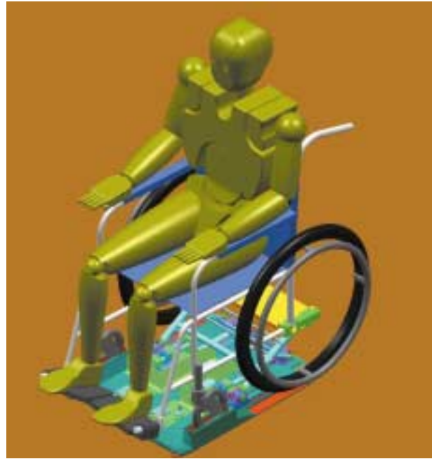
図4 製品型車椅子用車載免振装置プロトタイプ概念図
