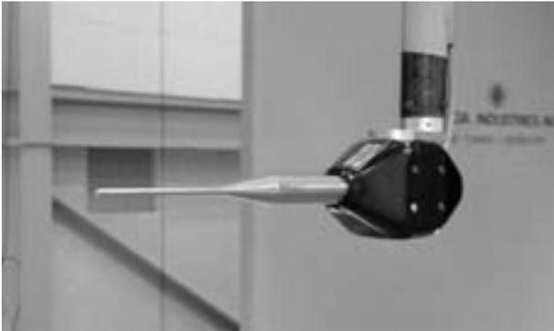
写真1 較正装置を内蔵した高応答性7孔管
