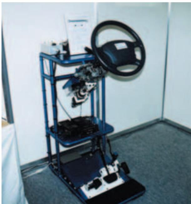
写真4 自動車運転補助装置
