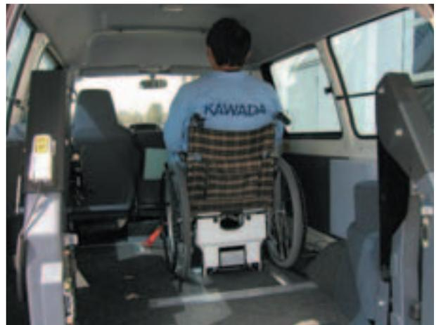
写真7 車椅子用アクティブ・サスペンション装置
