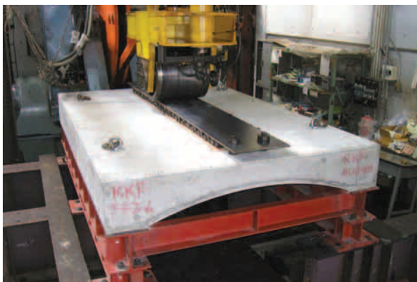
写真4 輪荷重走行試験載荷状況
