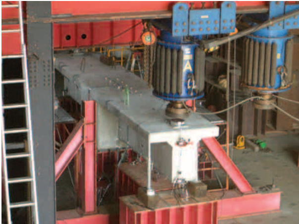
写真2 中間支点部の負曲げ試験の状況
