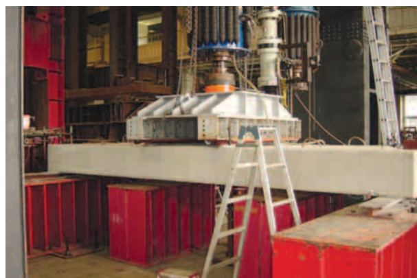
写真1 載荷試験状況（SCスラブ橋）
