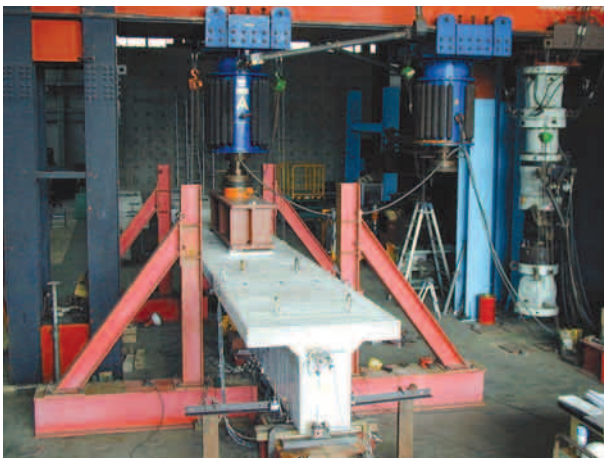
写真3 正曲げ荷重載荷試験の状況
