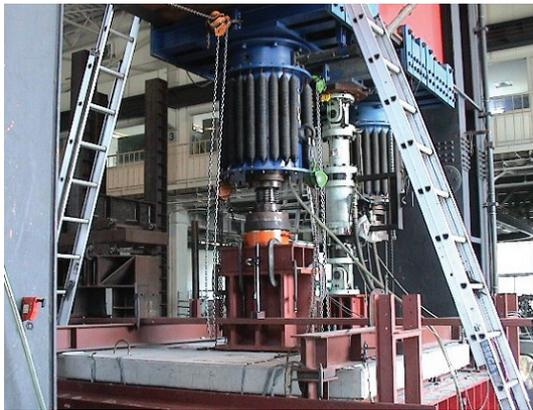
写真2 5000 kNジャッキによる破壊性状態確認試験の状況
