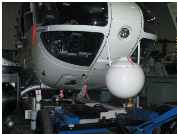
写真6 フロント側自動追尾アンテナ
