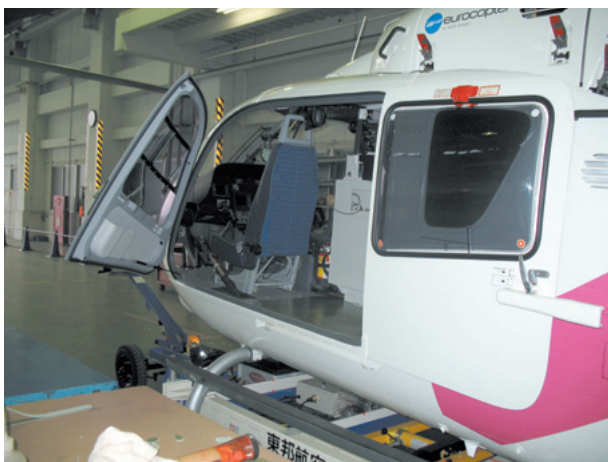
写真3 JA01EX号機の大型スライドドア
