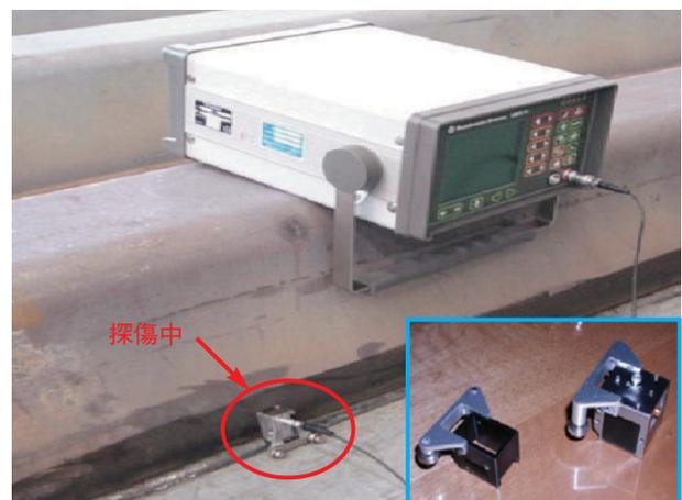
写真1 ガイドローラー探傷治具
