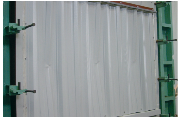
写真 8 No.2 試験体の破壊状況 (K. ウォール)
