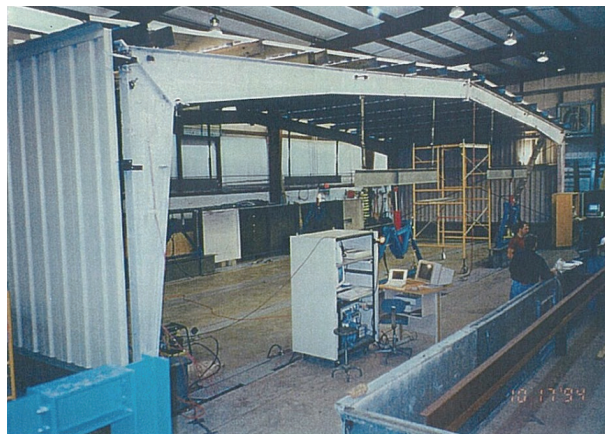
写真6 鉛直載荷実物大試験
