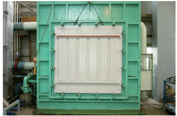
写真 7 試験体セット状況 (K. ウォール)
