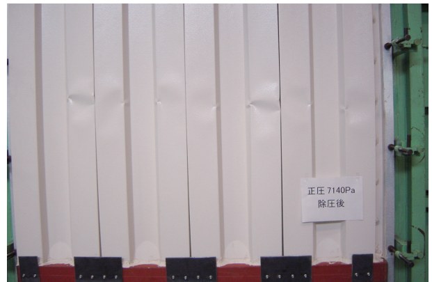
写真 9 No.5 試験体の破壊状況 (J. ウォール)
