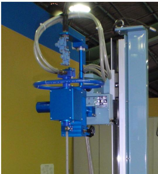
写真6 ノズル回転法エレクトロスラグ溶接機
