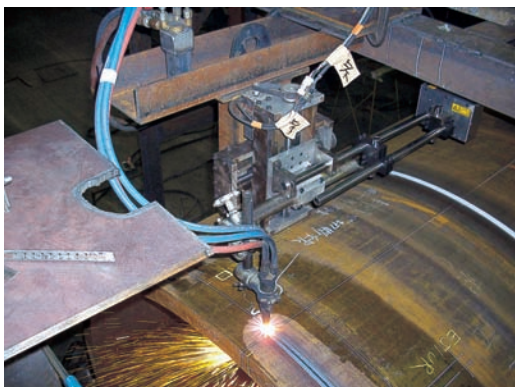
鋼管切断状況写真(切断機)
