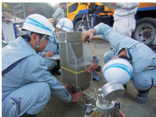
写真4 自己充てん性確認状況
