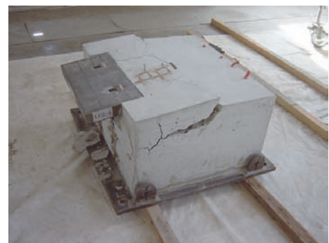
写真2 モデルBのコンクリートひび割れ状況
