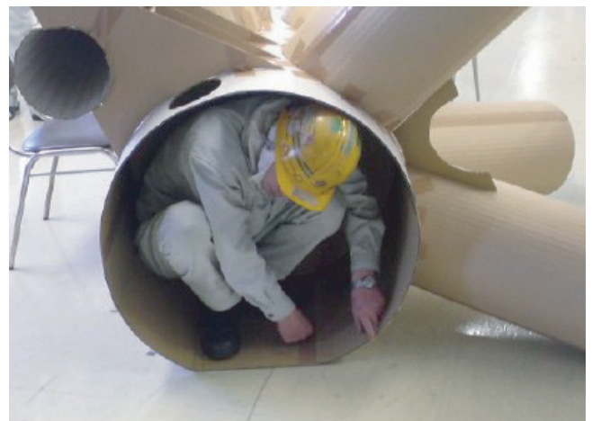
写真5 溶接の作業性確認状況
