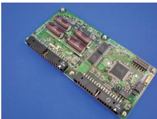
図4. 自社開発のDCブラシレスモータドライバ
