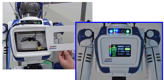
図11 胴体背面の機器搭載スペース
