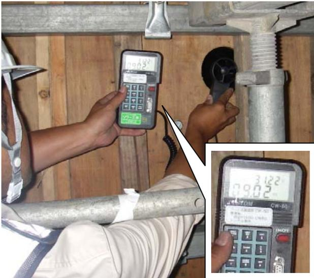
写真3 風速の確認状況
