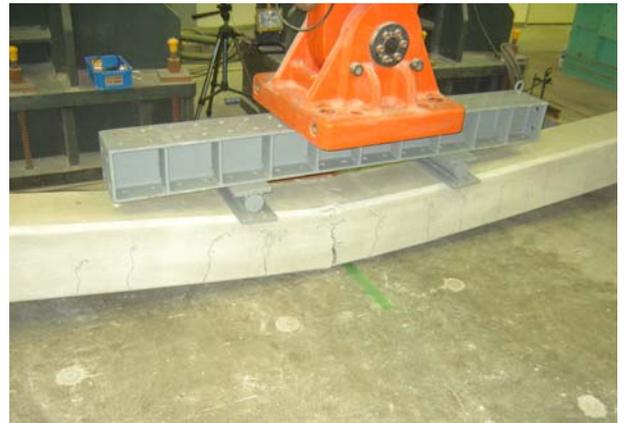
写真 6 RC ストラット耐力試験状況
