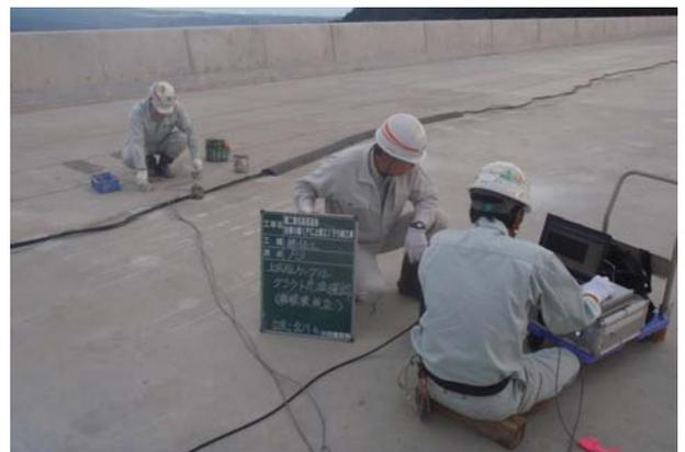
写真 15 グラウト充填非破壊検査状況
