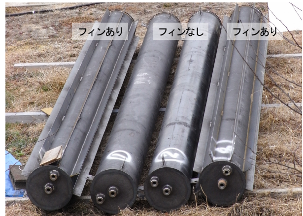
写真4 熱交換器の外観
