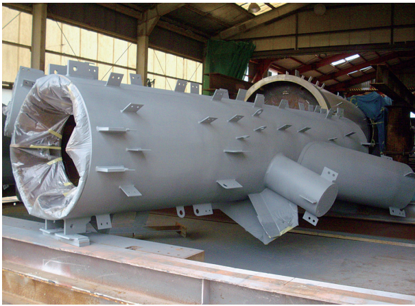
【下塗り塗装完了】
