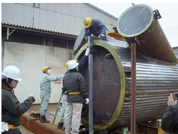
【製品検査 柱端面精度確認】
