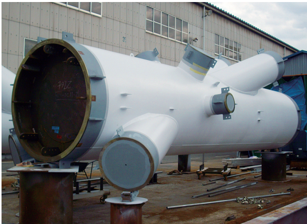
【上塗り塗装完了】
