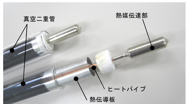
写真2 真空管型集熱器の端部構造
