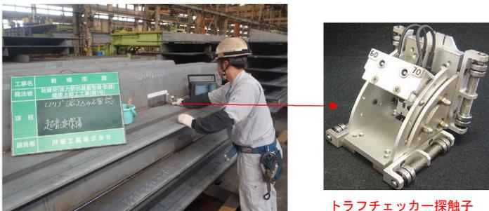
図4 トラフチェッカーによる製品確認
