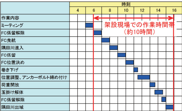
図9 架設タイムスケジュール（側径間）
