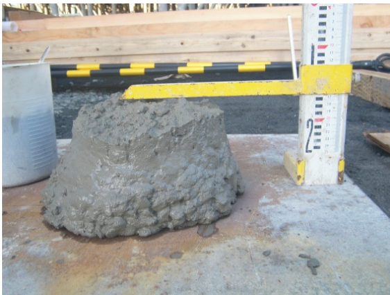
写真3 スランブ試験
