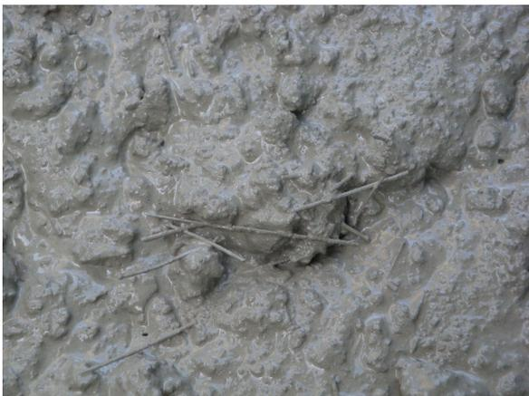
写真 9(2) バルチップ MK (練り混ぜ状態)
