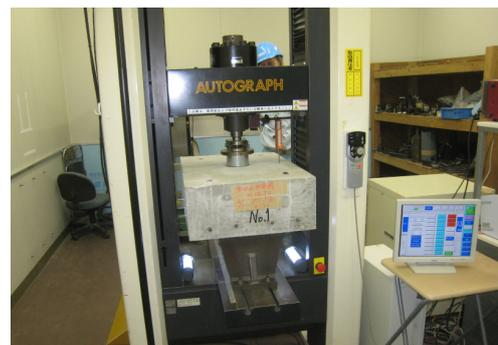
写真8 押し抜き試験状況
