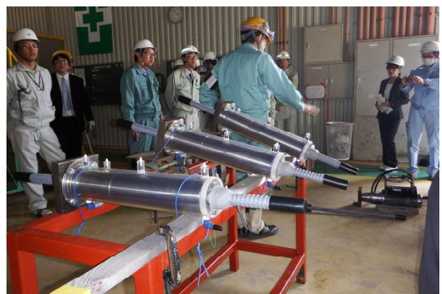
写真 3 充填確認試験 試験体
