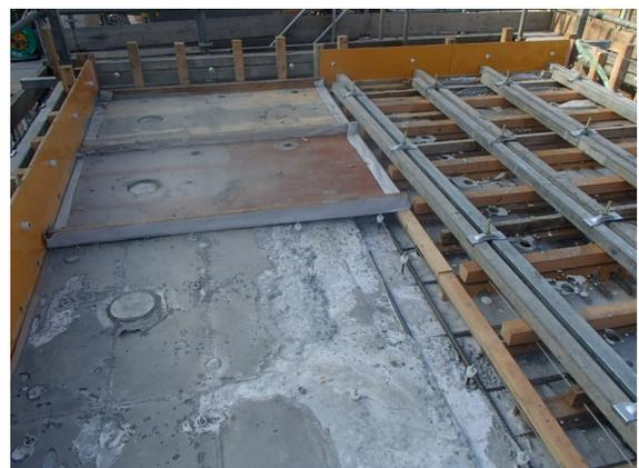
写真3 上床版試験体の未充填状況
