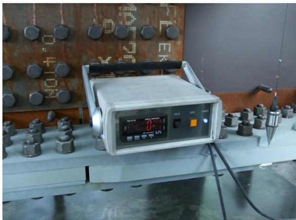
写真3 デジタル荷重計（ポンプ操作用）
