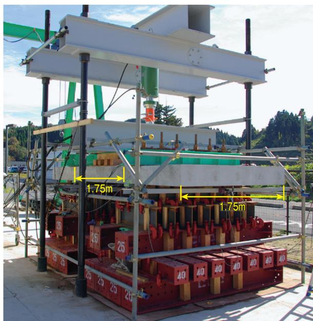
写真4 プレキャストPC床版の押抜き載荷試験の外観
