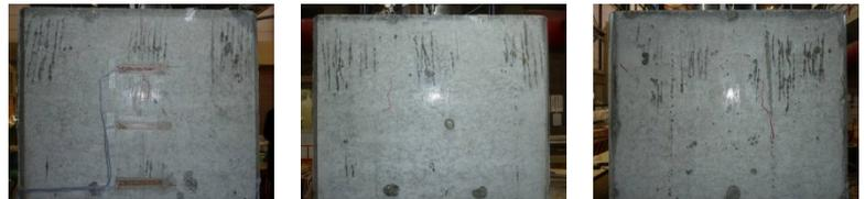
写真1 荷重段階cにおける試験体のひび割れ発生状況
