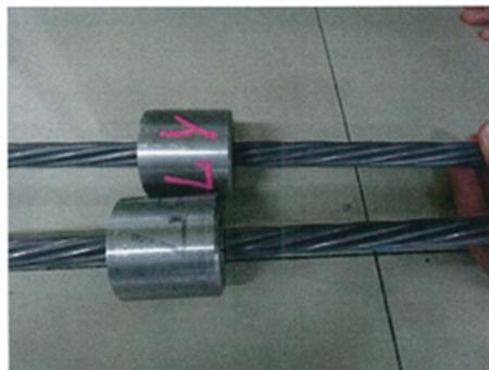
写真3 疲労試験後の試験体状況
