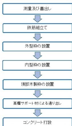
図 2 施工手順フロー
