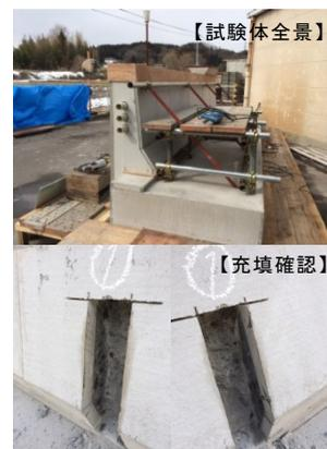
写真1 フロリダ型充填実験
