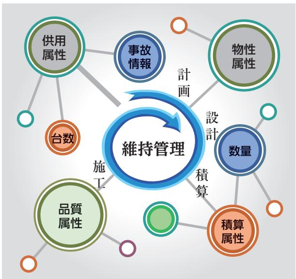
この戦略概念の特徴は、第1に計画・設計、製作施工、維持管理の各フェーズで付加される各種多様な属性情報の分断を解消すること、第2に各フェーズにおけるデータベースの運用を容易にすることである。上記特徴は現状課題と表裏一体であり、特に第2についてはデータ属性の追加・削除および新たなデータベースの追加が容易であること、データベースのアクセススピード、データベースの変更に伴う関連ソフトウェアへの影響を小さくすることを目的としている。3次元モデルデータの代表的なデータ交換形式として IFC (Industry Foundation Classes) があるが、データへのアクセスがいわゆる「重い」ため、実用には向かないを感じている。そこで最終成果物を IFC でデータ保存するために、各フェーズで作成された CIM モデルを運用時に並行活用できる情報共有のプラットホームを構築中である。
