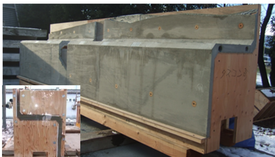
写真3 ゲルバー充填試験実物大供試体
