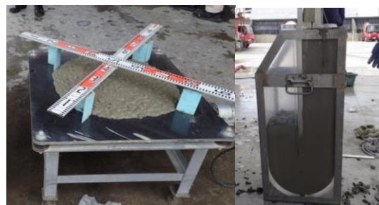
写真1 加振スランプ試験（左）およびU形充填試験（右）の状況
