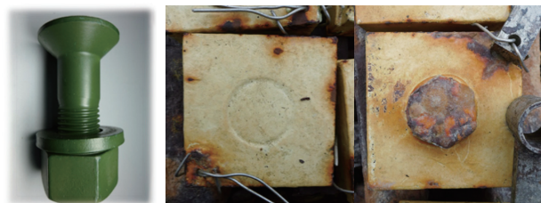
(a) 外観 (b) 皿型高力ボルト (c) 高力六角ボルト 図7 摩擦接合用皿型高力ボルトと暴露試験結果(3年間)
