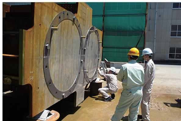
写真6 幅4mあまりの免震装置受け部材
