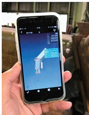
写真4 レーザートラッカーのスマートフォンアプリ
